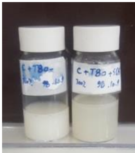
شکل ۱- برخی از نانومولسیون‌های میخک تولید شده با استفاده از توئین ۸۰ به تنهایی و ترکیب با SDS که باعث تفاوت در رنگ ظاهری و پایداری شده است.
