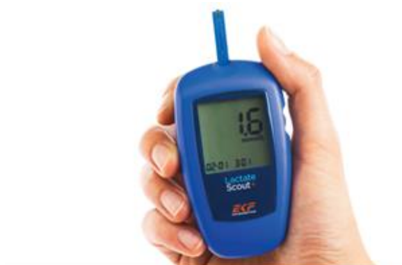
شکل ۱. لاکتات اسکات، دستگاه سنجش لاکتات
