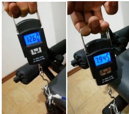
شکل ۵. اندازه گیری مقاومت دستگاه توسط نیروسنج دیجیتال برای سنجش روایی در مقاومت های ۸ و ۱۲٫۵ کیلوگرم
