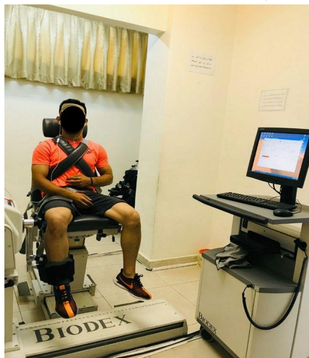
شکل ۱: اندازه‌گیری حس عمقی زانو
