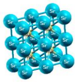
شکل ۱. الف) ساختار NaCl سولفید استرانسیوم
