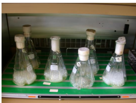
شکل ۴. تولید رامنولیپید درون ارلن‌های ۱۰۰۰ میلی‌لیتری در یک شیکرانکویاتور (۳۷°C و ۱۲۰ rpm) در حین تولید رامنولیپید کف تولید می‌شود.
