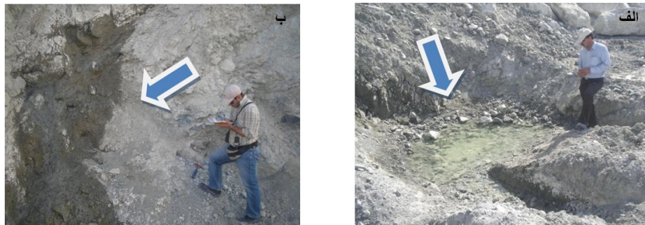
شکل ۲۲. الف) خروج آب در راستای صفحه درز J=N062/50 (دید به سمت شمال خاور) ب) خروج آب از درون افیولیت‌ها
