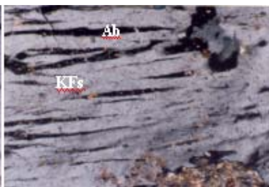
شکل ۸. نمایش بافت پرتیت (هم‌رشدی آلبیت و فلدسپات پتاسیک) در توده گرانیتی شمال موته (×100.XPL). فلدسپات پتاسیک = Kfs و آلبیت = Ab
