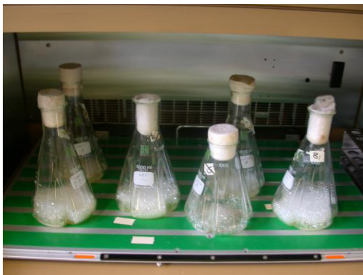
شکل ۴. تولید رامنولیپید درون ارلن‌های ۱۰۰۰ میلی‌لیتری در یک شیکرانکوباتور (۳۷°C و ۱۲۰ rpm) در حین تولید رامنولیپید کف تولید می‌شود.
