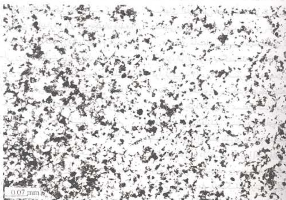
شکل ۶- رخساره سیلتستونی در زیر میکروسکوپ (نورپلاریزه).
