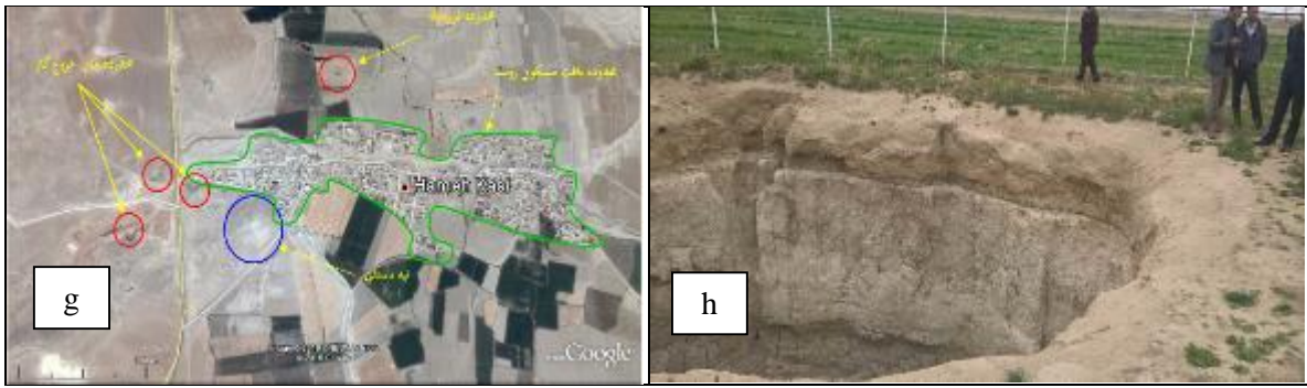
شکل ۱۴: a: نمایی از وضعیت نشست ساختمان ها در شهر فراغی b: نمایی از ترک خوردگی دیوار در اثر فرورانشست در شهر فراغی، c و d: شکاف های ایجاد شده در اثر فرورانشست زمین در روستای خلیج، e: شکاف های ایجاد شده در اثر فرورانشست زمین در روستای قادرآباد f: بیرون زدگی لوله جدار چاه در اثر فرورانشست زمین در روستای قادرآباد، g: موقعیت فروچاله نسبت به بافت مسکونی روستای همه کسی، h: فروچاله ایجاد شده در زمین های کشاورزی در ۱۵۰ متری شمال روستای همه کسی
