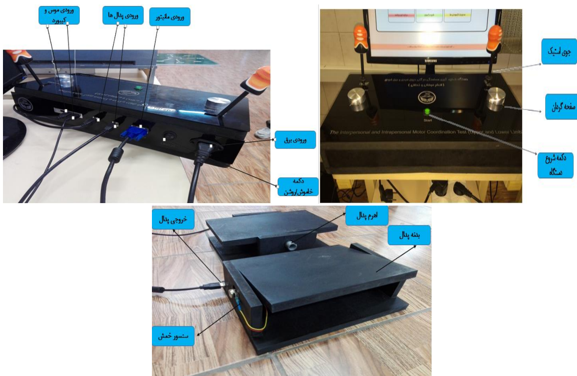
شکل ۵. بخش های سخت افزاری دستگاه هماهنگی حرکتی
