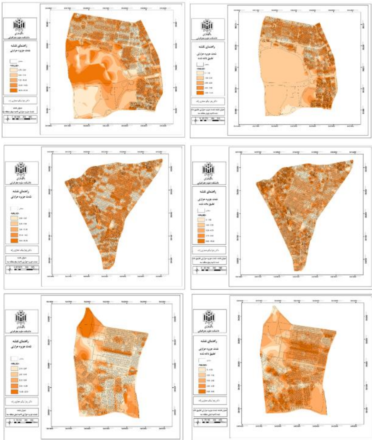
شکل (۱۱). نقشه حداکثر شدت جزیره حرارتی ناحیه (۴-۶) (سمت چپ از بالا به پایین) و حداکثر شدت جزیره حرارتی تطبیق داده شده ناحیه (۴-۶) منطقه سه تهران (سمت راست از بالا به پایین)
