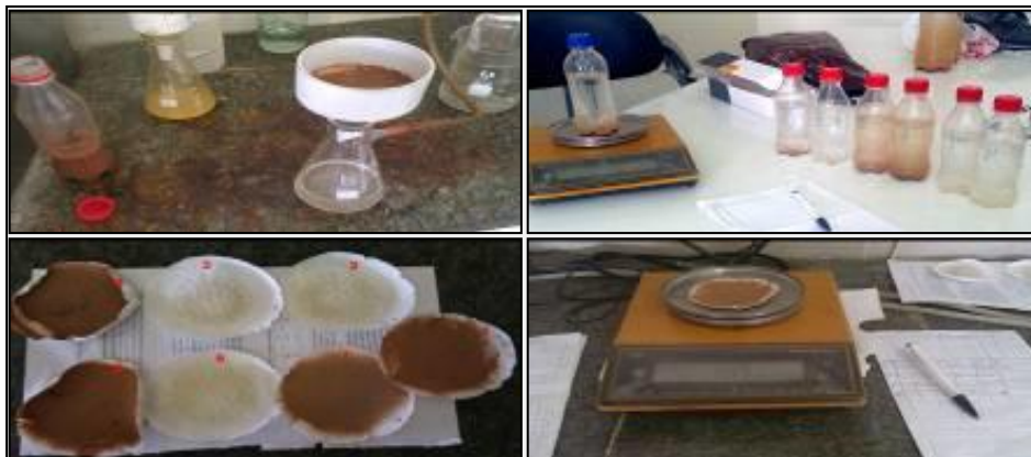
شکل (۱۰) مراحل محاسبه میزان درصد رسوب نمونه آب رودخانه کلاته سادات. (منبع: نگارندگان)
