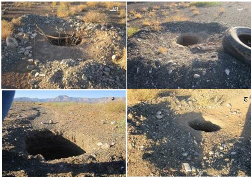
شکل (۲). تصاویر چاههای حفر شده در راس مخروط قدیمی (الف) میانه مخروط قدیمی (ب) میانه مخروط جدید (ج) انتهای مخروط قدیمی (د)
