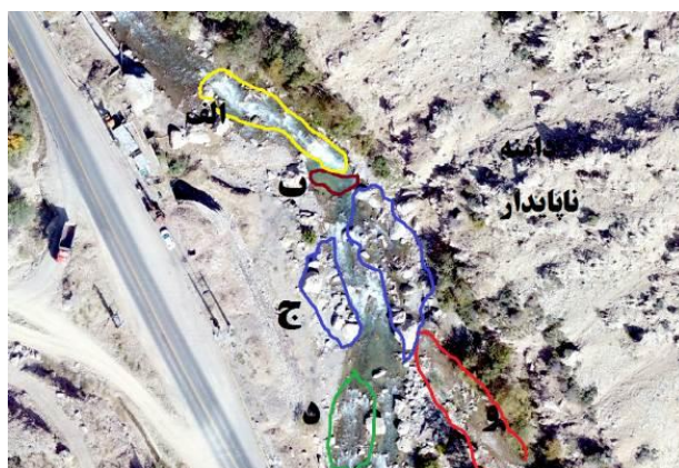
شکل (۱۳). الف) سکوه‌های پله ای (ب) چالاب، ج) رخنمون های سنگی، د) خیز آب. و) دو کانال شدن رودخانه به دلیل موانع طولی در بازه ۶
