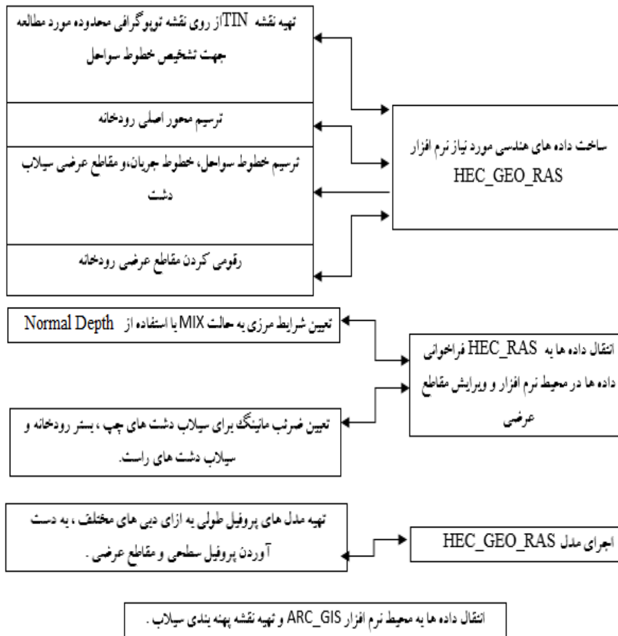
شکل (۱): مدل شماتیک از نحوه اجرای مدل HEC_RAS
