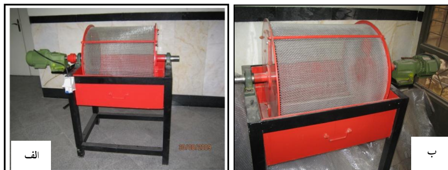
شکل ۳. الف و ب) دستگاه دوام بزرگ مقیاس
