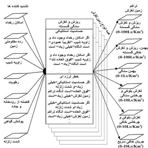
شکل ۷. نمودار جریانی داده‌ها بر ای بخش خطر CAMEL، معرف ورودی‌ها (اطلاعات تشدید کننده)، خروجی‌ها، و ترتیب قواعد [۱۰]، [۱۱]، [۱۲]
