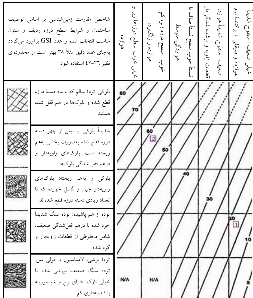
شکل ۸. طبقه‌بندی GSI توده‌های سنگی منطقه
