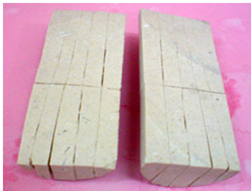
شکل ۵. نمونه دارای سه دسته ناپیوستگی متقاطع و عمود برهم، یکی دسته ناپیوستگی با زاویه ۹۰ درجه دارای ۴ ناپیوستگی موازی است و در جهت دسته قائم برای نمایش از وسط باز شده است.
