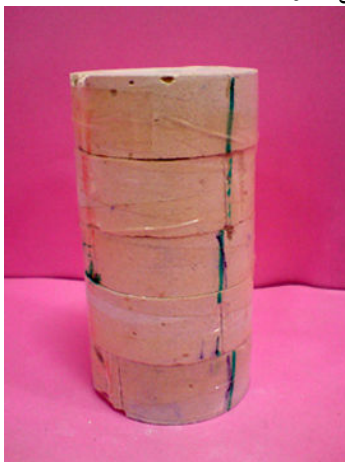
شکل ۱. دودسته ناپیوستگی قائم و عمود برهم و یک‌دسته در جهت افقی و دارای ۴ ناپیوستگی موازی
