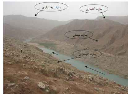
شکل ۴. موقعیت سازندهای زمین‌شناسی در مخزن سد گتوند
