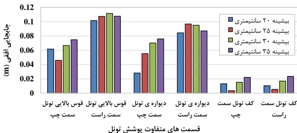
شکل ۱۶. بیشینه مقادیر جابجایی افقی در قسمت های متفاوت تونل با ضخامت متفاوت پوشش
