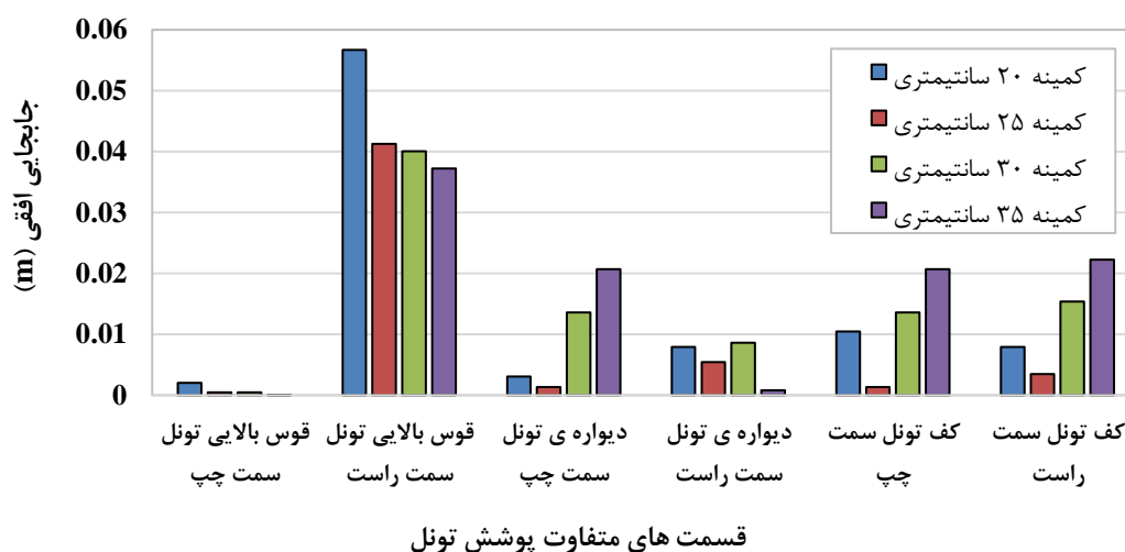
شکل ۱۷. کمینه مقادیر جابجایی افقی در قسمت های متفاوت تونل با ضخامت متفاوت پوشش
