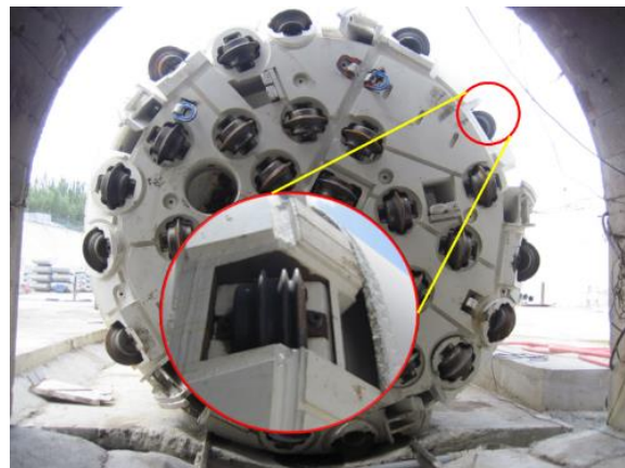
شکل ۷. قابلیت اضافه حفاری ماشین حفار در مناطق فشرده Fig. 7. Over cutting system for squeezing zone
