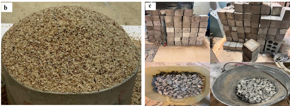
شکل ۱- (a) منحنی دانه‌بندی ماسه، (b) ماسه مورد استفاده، (c) ضایعات بتنی
