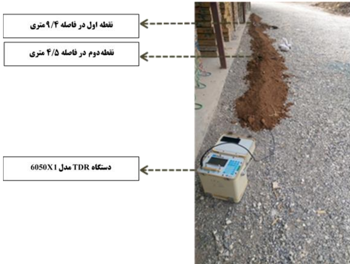
شکل ۶. تصویر آزمایش ارزیابی تأثیر رطوبت خاک اطراف سنسور TDR بر شکل موج آن و موقعیت نقاطی که رطوبت خاک به صورت پله‌ای افزایش داده شد.
