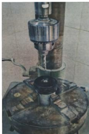
شکل ۲. سوراخ کاری نمونه‌های سیمانی
