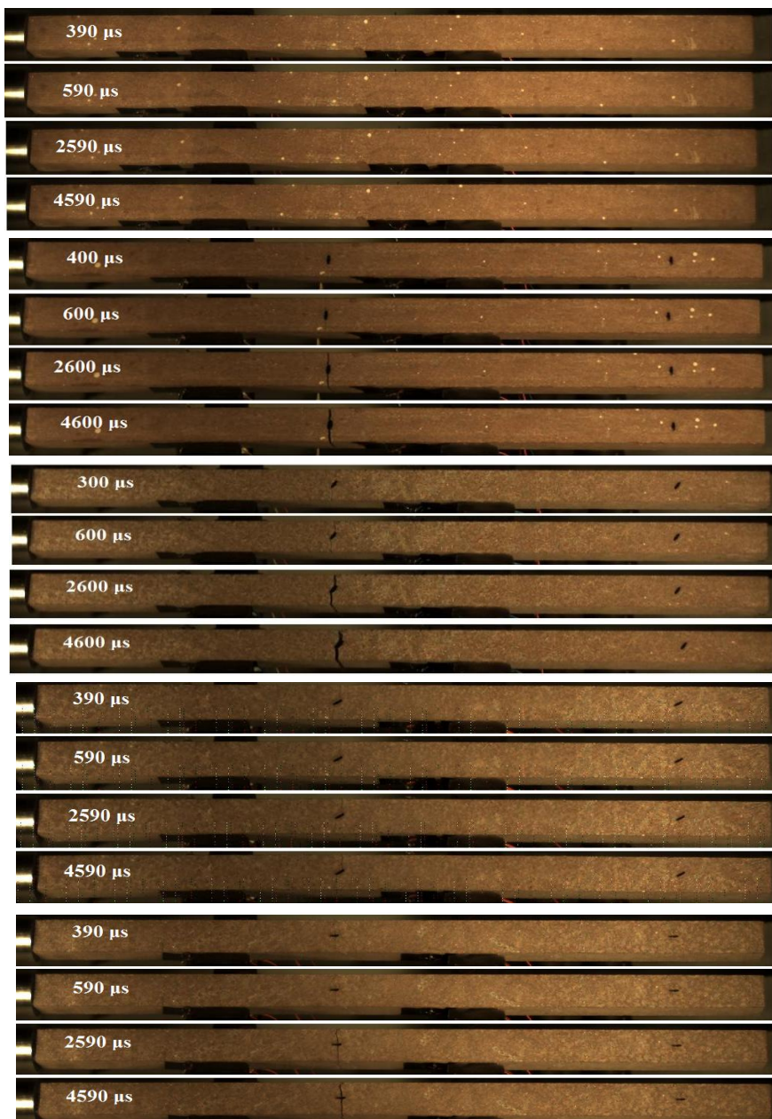
شکل ۶. نحوه گسیختگی اسپالینگ نمونه‌ها در آزمون بارگذاری دینامیکی
