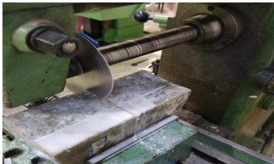
شکل ۳. نحوه ایجاد ترک در قطعات نیم‌دیسک
