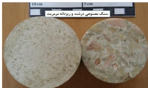
شکل ۳. سنگ مصنوعی ریزدانه و درشت‌دانه ساخته شده از ۷ نوع سنگ‌دانه سنگ ساختمانی کربناته
