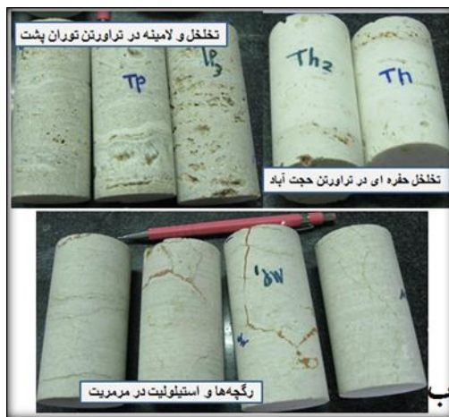
شکل ۱۴. الف) وجود ۳ سطح رخ و سستی بلورهای درشت کلسیت در مرمر، ب) خلل و فرج و لامینه در تراورتن، وجود رگچه‌ها و استیلولیت در مرمریت
