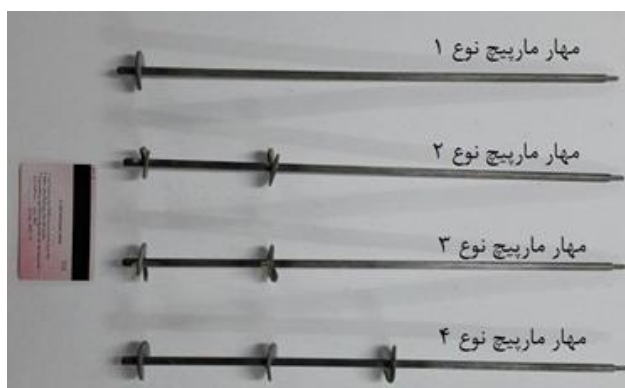
شکل ۳. چهار نوع مهار مارپیچ استفاده شده در آزمایش جدول ۳. مشخصات مهارهای آزمایش شده
