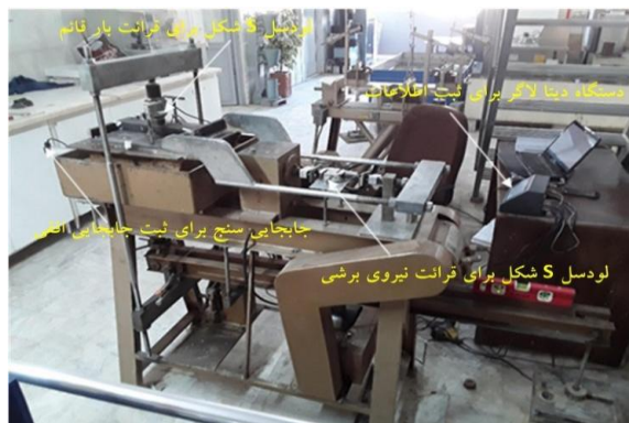
شکل ۵. دستگاه برش مستقیم و تجهیزات نصب‌شده روی آن
