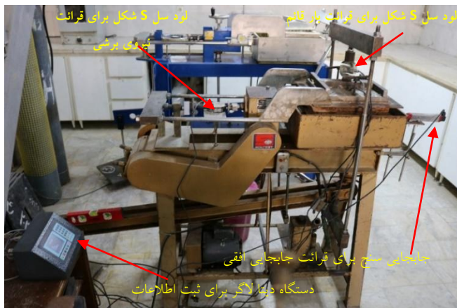
شکل ۳. دستگاه برش مستقیم و تجهیزات نصب‌شده بر روی آن
