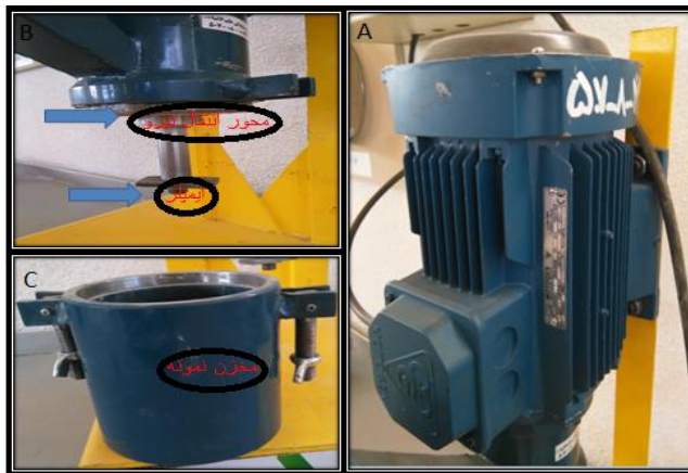
شکل ۱. بخش‌های اصلی دستگاه LCPC (الف) الکتروموتور تامین کننده نیروی محرکه دستگاه، (ب) محور انتقال نیرو و تیغه فلزی، (ج) مخزن نمونه
