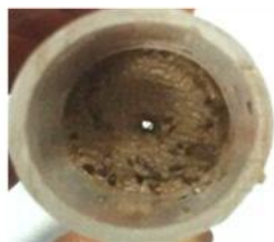
تغییر قطر سوراخ در پایان آزمایش در نمونه خاک منطقه بق قجه بالا یا دانسته حداکثر
