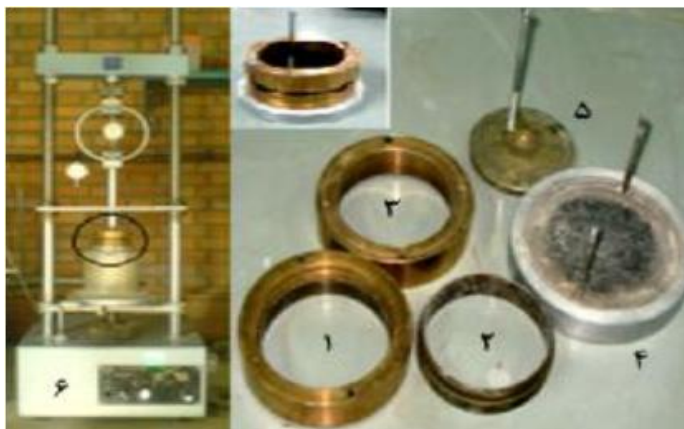
شکل ۱. قالب تراکم استفاده شده برای ساخت نمونه‌ها
