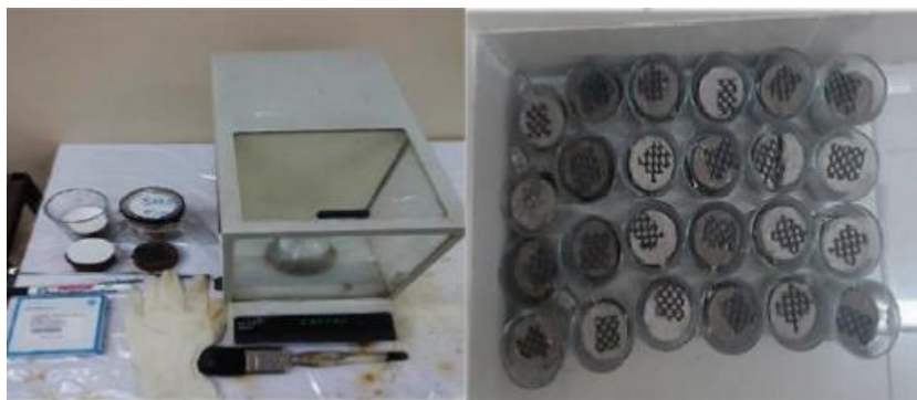
شکل ۵. سمت راست، نمونه‌های اشباع درون ظرف و سمت چپ، تجهیزات مربوط به آزمایش فیلتر کاغذی برای تخمین آزمایش مکش
