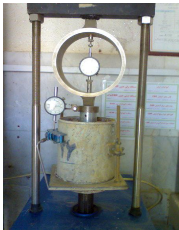
شکل ۷. انجام آزمون نسبت باربری کالیفرنیا در حالت خشک روی نمونه‌های بررسی شده
