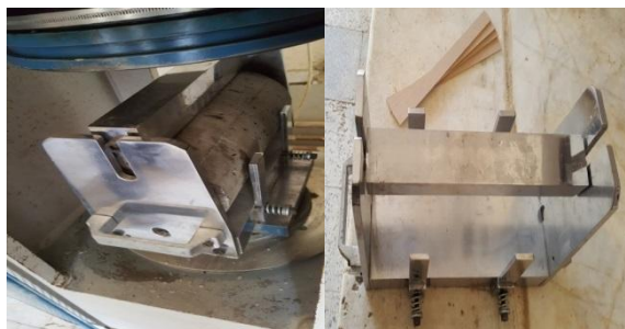
شکل ۱۰. گیره مناسب برای نمونه ۱۵۰ در ۳۰۰ میلی‌متری
