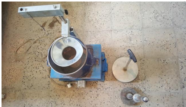
شکل ۹. میز لرزه به همراه ملحقات
