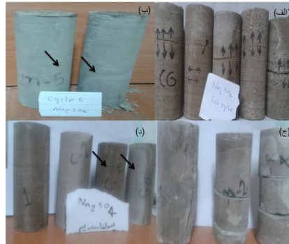
شکل ۹. تخریب نوع دوم: تخریب اتفاق افتاده در نمونه‌های ماسه سنگی در امتداد سطوح ضعف از پیش موجود و لامینه‌ها، الف) نمونه CG، ب و ج) نمونه Min و د) نمونه C. (قطر نمونه‌ها ۵/۴ سانتی‌متر و طول آن‌ها ۱۴ سانتی‌متر است)
