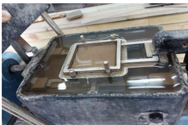
شکل ۳. نحوه قرار گیری نمونه غیرمسلح در داخل آب در دستگاه برش مستقیم
