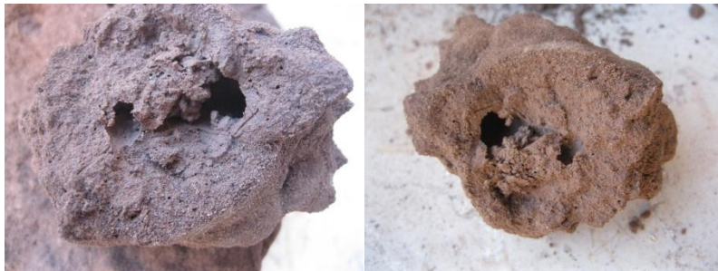
شکل ۱۵. آثار حفرات ناشی از انحلال (نمونه ۲۱)
