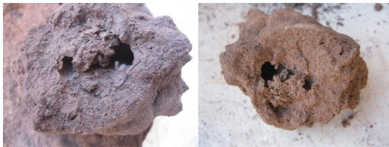
شکل ۱۵. آثار حفرات ناشی از انحلال (نمونه ۲۱)
