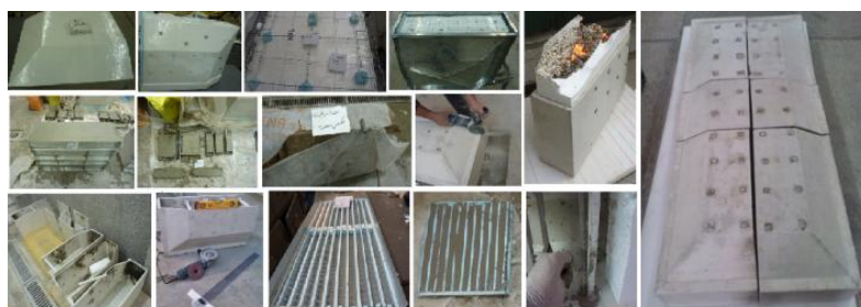
شکل ۶. مراحل ساخت مدل مخزن
