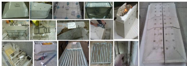
شکل ۶. مراحل ساخت مدل مخزن
