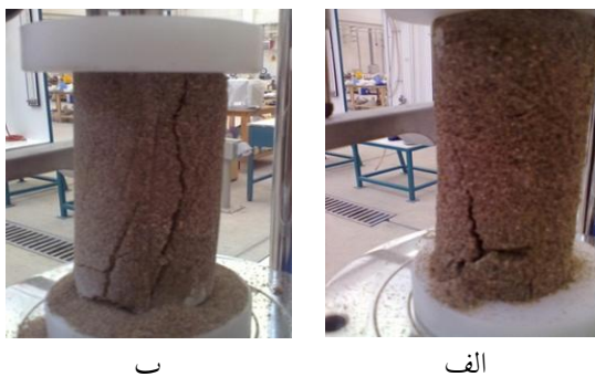
شکل ۸. آزمایش مقاومت فشاری تک محوره (UCS)، الف) نحوه شکست نمونه بهسازی شده به روش تزریق متداول، ب) نحوه شکست نمونه بهسازی شده به روش تزریق جدید پیشنهادی
