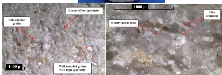
شکل ۳. الف) مقطعی از نمونه تهیه شده به قطر ۵۰ میلی‌متر، ب) نمایش توزیع و شکل دانه‌های اولیه کوارتز با مقیاس ۱۰۰۰ میکرون و ج) سیمان‌شدگی سیلیکاته دانه‌های اولیه با مقیاس ۱۰۰۰ میکرون
