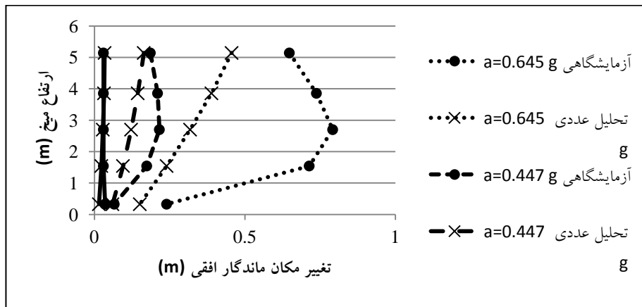
شکل ۴: نتایج تحلیل عددی و آزمایشگاهی آزمایش میز لرزان
