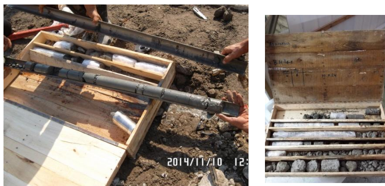
شکل ۸. جعبه نمونه محتوی مغزه‌های شکل ۹. مته سه جداره مغزه‌گیری به همراه محفظه به‌دست‌آمده از ستون L6-1 تا عمق ۶ متر
