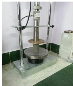
شکل ۱۰. بارگذاری تک‌محوری مغزه جدول ۵. نتایج آزمایش تک‌محوری مغزه‌ها
